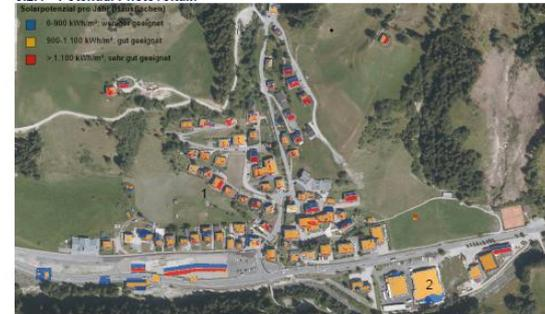
Die Dachflächen der einzelnen Gebäude weisen ein gutes Potential für die Solarenergieumwandlung auf (1.000 kWh/m<sup>2</sup>a). Wie in den folgenden Abbildungen für zwei typische Gebäude dargestellt, beträgt die mittlere Sonnenscheindauer im Sommer rund 12 Stunden pro Tag. Im Jänner und Dezember hingegen ist mit keinen bzw. im Februar und November im südlichen Bereich mit äußerst geringen Solarerträgen zu rechnen.
