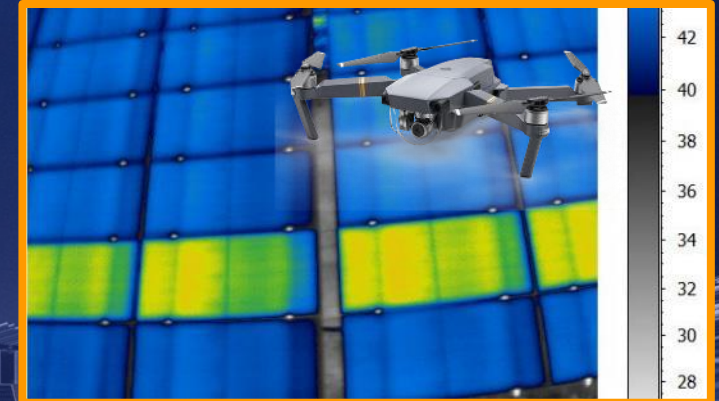
Thermografie mit Drohne
