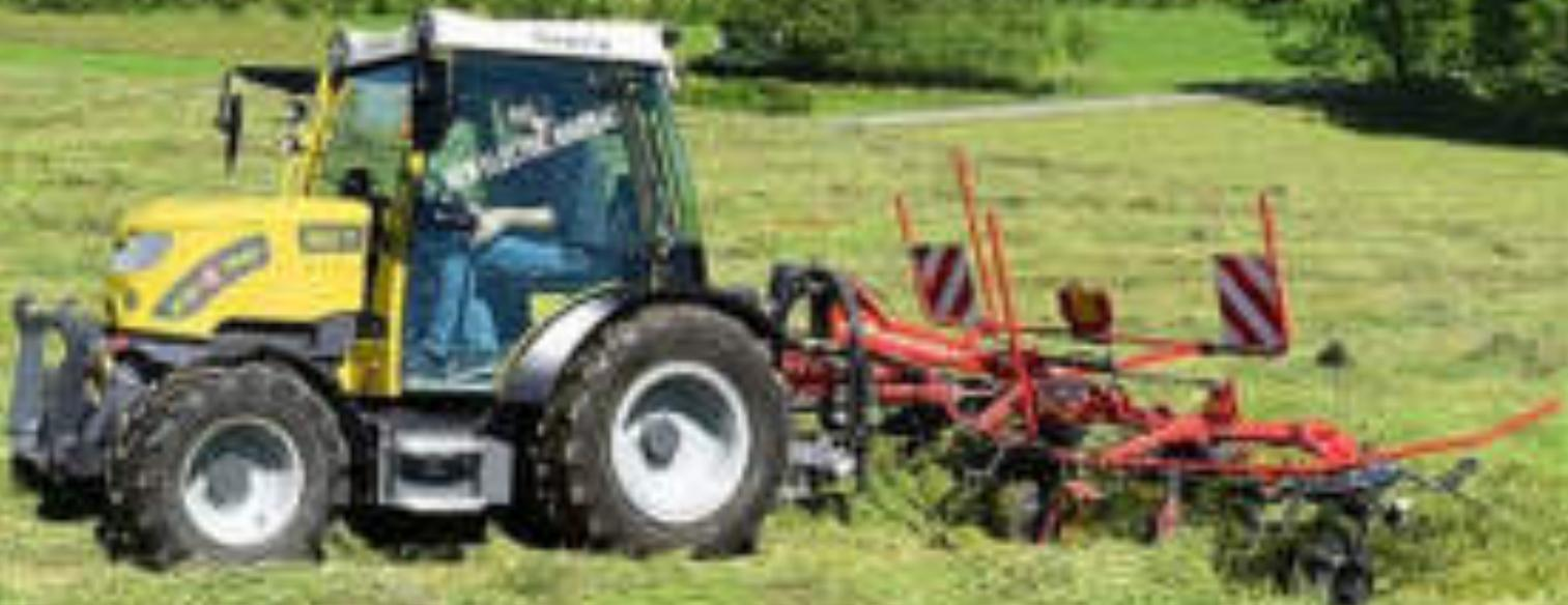
**100% Batterie/solar elektrisch, autonom, bis zu 5 km/h
