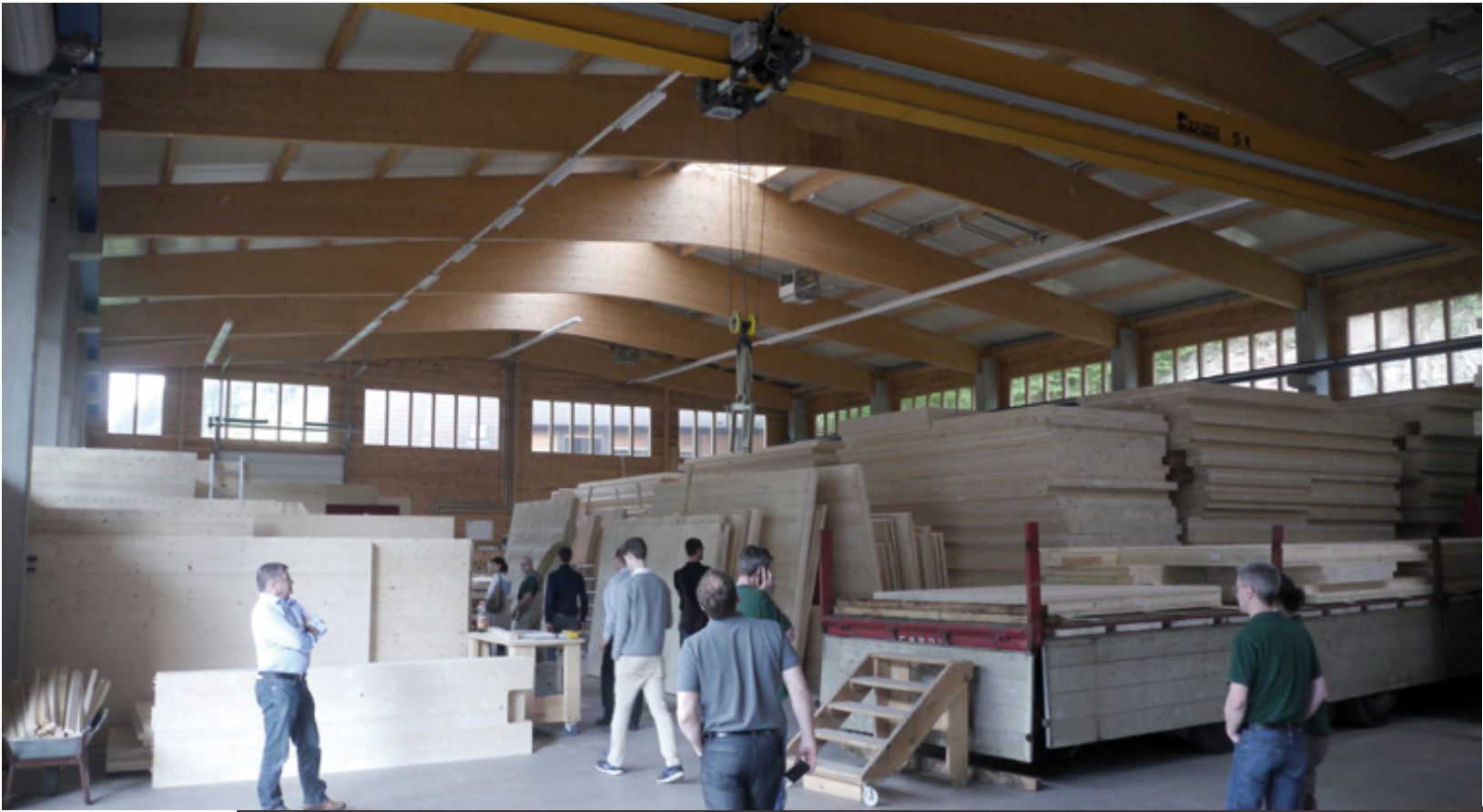
VERLADUNG DER FERTIGEN NUR-HOLZ ELEMENTE.
