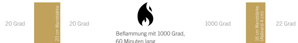
BRANDVERSUCH IN JAPAN MIT 20 CM STARKEM NUR-HOLZ WANDELEMENT IM VERGLEICH ZU BETONWAND. VERGLEICH DER ISOLIERFÄHIGKEIT VON HOLZ UND BETON.
