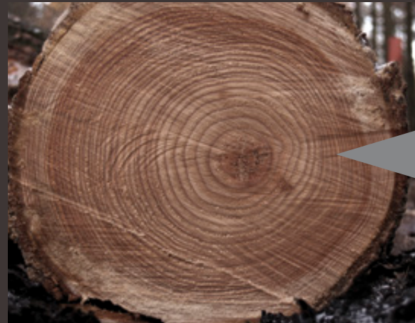
Die kleinen Luftpolster innerhalb der Holzstruktur dienen als natürlicher Wärmespeicher. Bilder: Wikimedia, Holzforschung München.
