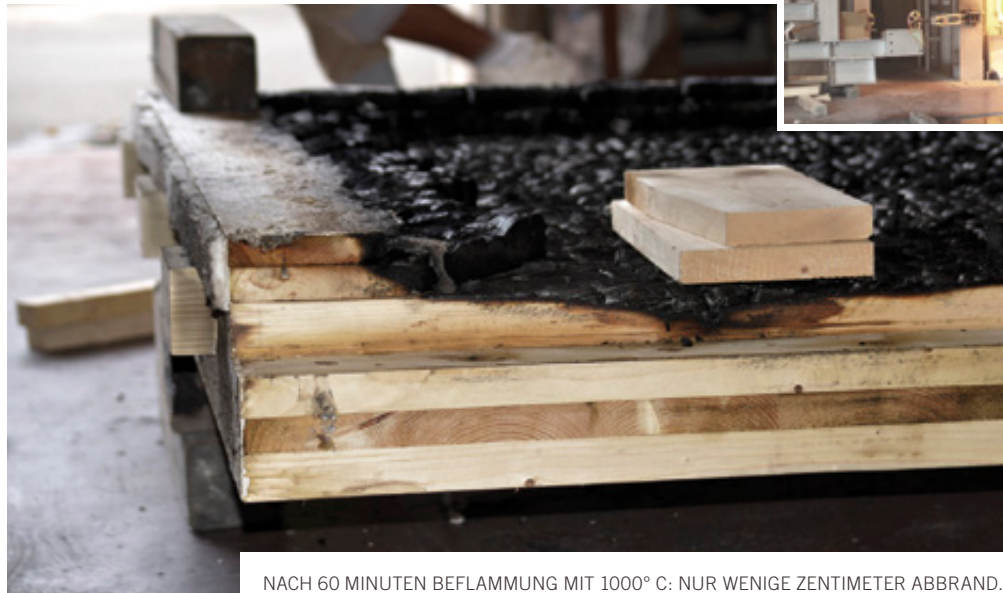
NACH 60 MINUTEN BEFLAMMUNG MIT 1000° C: NUR WENIGE ZENTIMETER ABBRAND.
